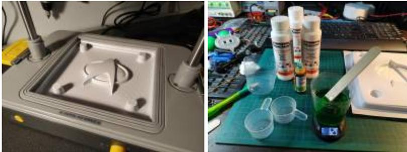
Durch einen erfolgreich durchlaufenen Mittelantrag besitzt der Hackerspace Bremen e.V. seit Anfang Juli ein sogenanntes „Tiefziehgerät“, mit dem man z.B. Gußformen über 3D-Druckteile erstellen kann, um diese dann mit anderen Materialien (z.B. Zement, Gips, Kunstharz, Kerzenwachs, u.ä.) abzuformen.
