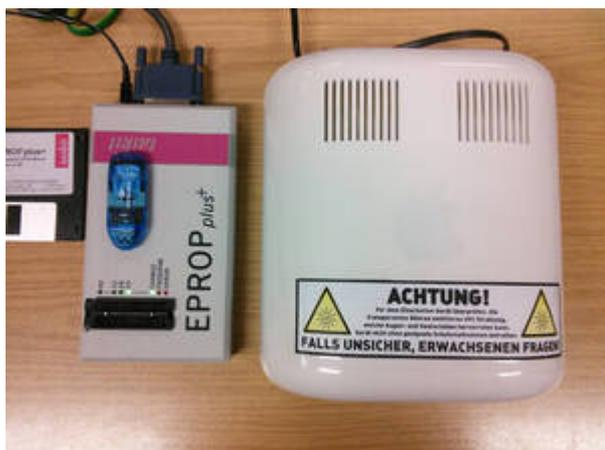
Der Taskit EPROP+ ist ein Geschenk an den Hackerspace Bremen eines Mitglieds aus dem <http://mikrocontroller.net> Forum. Das Gerät brennt parallele EPROMS, EEPROMS und Flashbausteine in DIL Gehäusen. Andere Gehäuseformen können über Adapter realisiert werden (muss man basteln).
