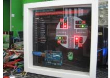
Mit diesem Schaustück kann man eine Ampelsteuerung programmieren. Im Inneren werkelt ein originaler Arduino Uno und schaltet über zwei ULN2803-Treiberstufen insgesamt 10 LED-Lampenpaare. Die Anschlußleitungen sind direkt von den Pins vom Arduino durch die Bodenplatte zur verkabelten Rückseite geführt.
