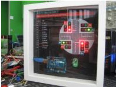
Mit diesem Schaustück kann man eine einfache Ampelsteuerung programmieren. Im Inneren werkelt ein originaler Arduino Uno und schaltet über zwei ULN2803-Treiberstufen insgesamt 10 LED-Lampenpaare (ein einzelner Anschlusspin vom Arduino kann nicht soviel Strom für zwei LED`s schalten, daher der zwischengeschaltete Treiber/elektronischer Verstärker).
