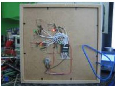
Info: Die Anschlußleitungen sind direkt von den Pins vom Arduino durch die Bodenplatte zur verkabelten Rückseite geführt.
