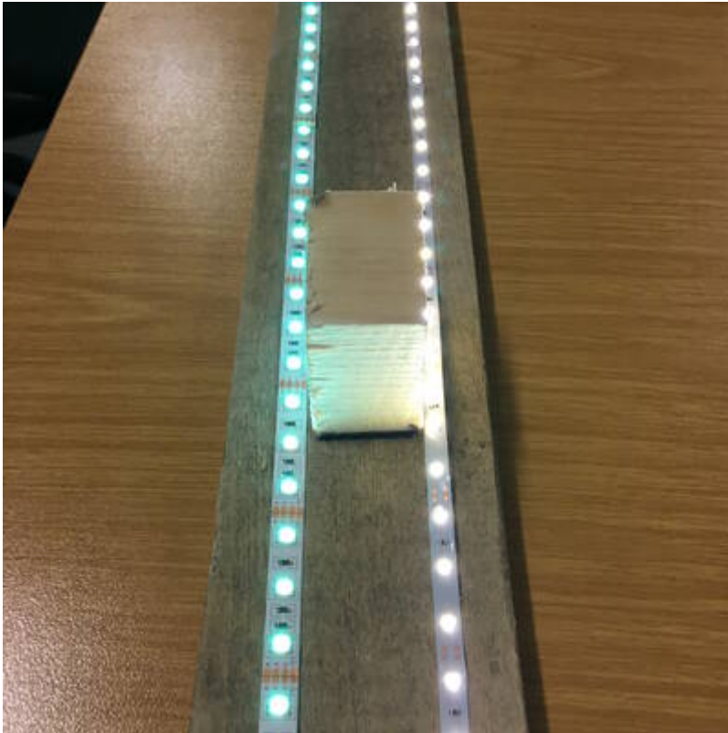
Erste Funktionstest für die LED-Stripes, die mit Klebeband auf der Holzleiste fixiert wurden.
