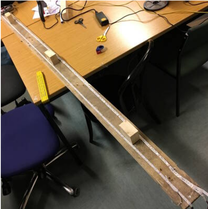
Abstandsblöcke für die Leiste mit Heißkleber auf der Holzleiste fixiert (halten den Abstand zur Wand)
