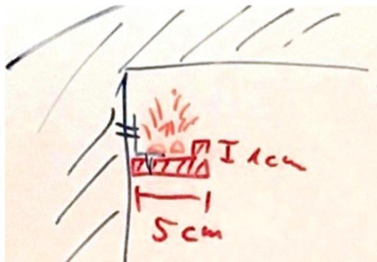
Abbildung : Prototyp aus Holzleiste mit aufgesetzter Vierkantleiste als Sichtblende und Stahlwinkeln zur Befestigung an der Wand, mit Platz für zwei LED-Stripes (Warmweiß+RGB).
