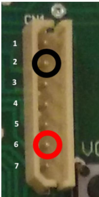
Mechanisch konnten die passenden Steckerweibchen nicht ermittelt werden. Daher greifen wir das Signal über zwei Einsätze gedrehter IC-Sockel ab, die in den Steckverbindern verlässlich halten.
