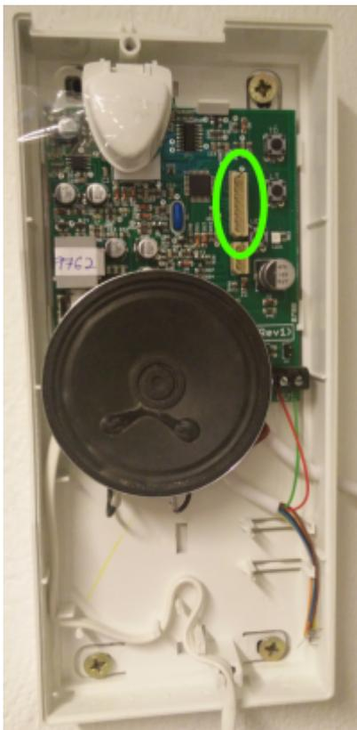
Die Belegung lässt sich durch ein Foto einer Relaisbox [AM333](#), die man hinzukaufen kann, erahnen. Ein Multimeter half bei der weiteren Analyse. Auf dem zweiten Pin von oben liegt Masse, auf dem zweiten Pin von unten wird das Klingelsignal ausgegeben.
